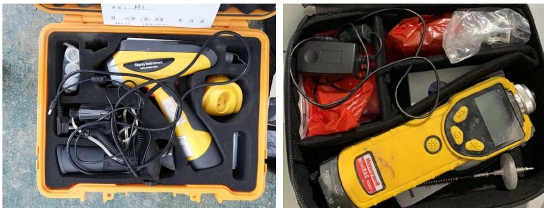
图 5-2 现场快速检测设备（左边为 XRF,右边为 PID）
